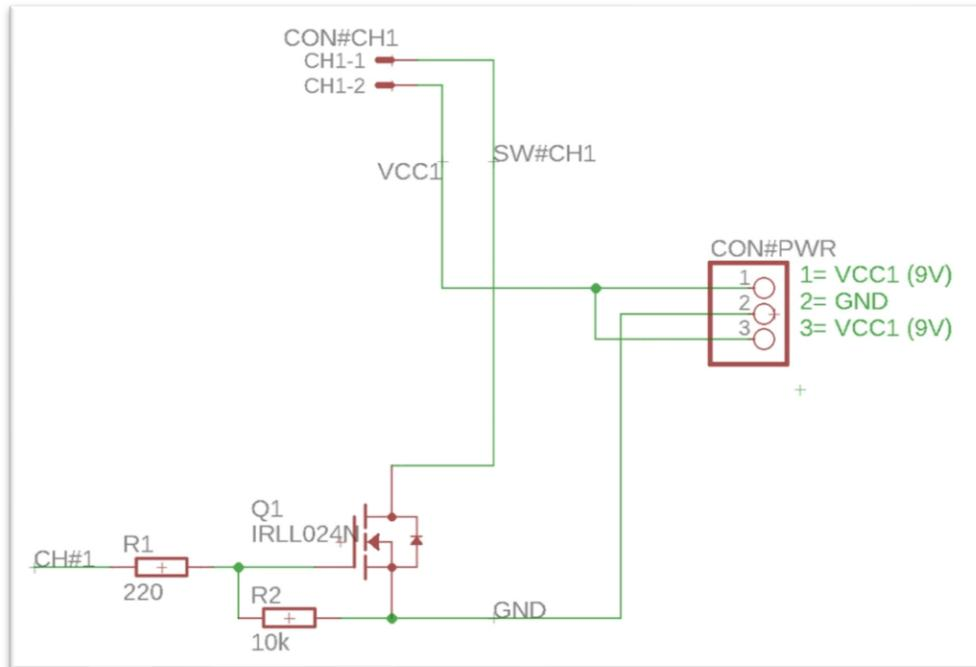
Figure 2 2,7A Channel Switch Schaltung
